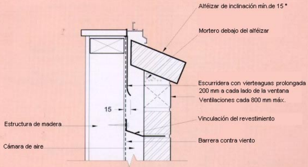
(A) DETALLE DE ALFEIZAR DE VENTANA CON REVESTIMIENTO
